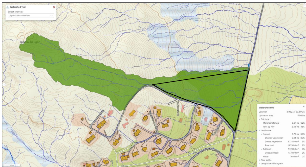
Figur 7: Dreneringslinjer med nedbørfelt for planområdet. Fra Scalgo Live. Planområdet er markert med svart.
