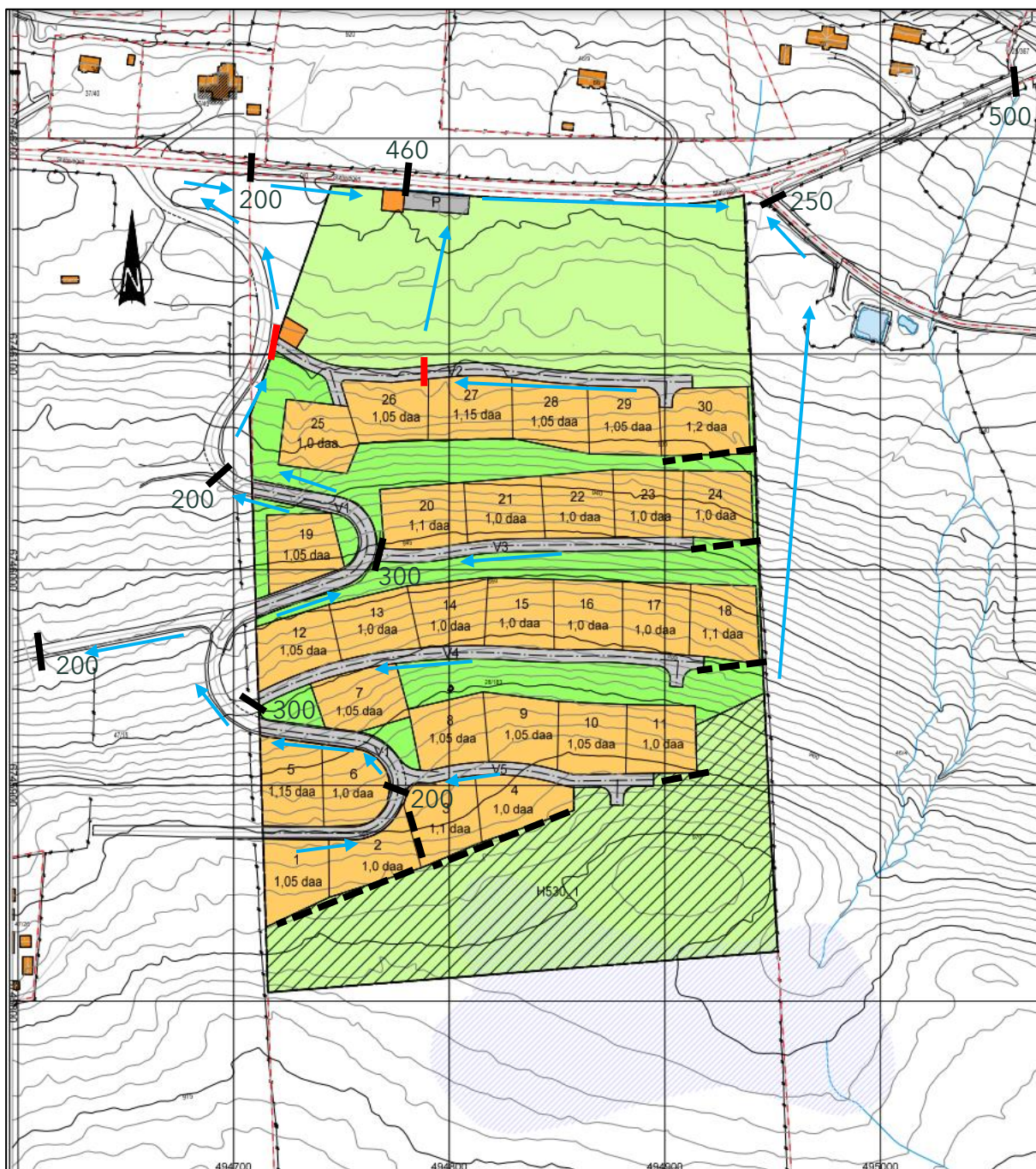
Figur 7: Eksisterende stikkrenner er markert med svart. Nye stikkrenner er markert med rødt. Nye avrenningslinjer er vist med blå piler. Avskjærende grøfter er vist med svart stiptet linje.
